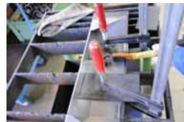
Auch Dünublech lässt sich mit Vorspannung richten!
